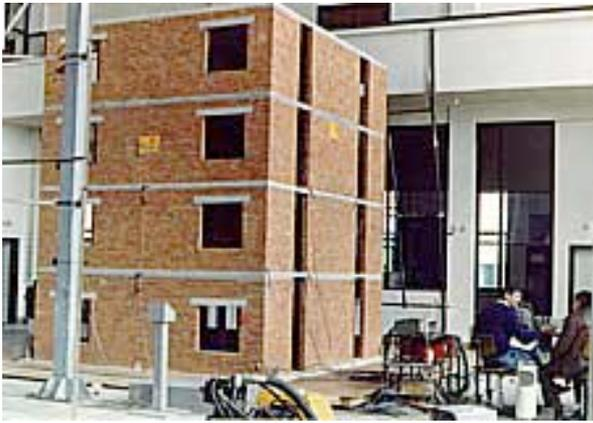
**Figure 2** Modelling of Mixed Reinforced Concrete Masonry Buildings at IZIIS Macedonia (joint program with Istituto di Tecnica Delle Costruzioni, Università di Bologna, Italy)
