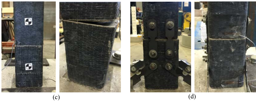
Fig. 5 Damage of the columns (a) C-N-N, (b) E-N-N, (c) E-Y-N, (d) E-Y-E
